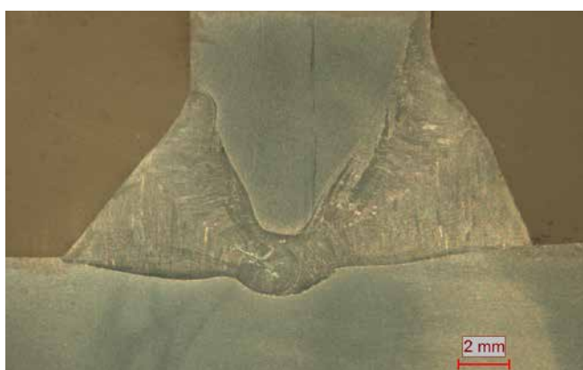
PB Spoina dwustronna z pełnym przetopem
