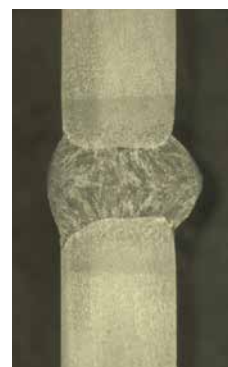
Grubość blachy 5 mm Szczelina 3 mm
