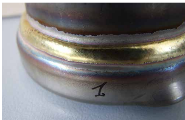
Lutowanie blach wysokostopowych (CrNi)
