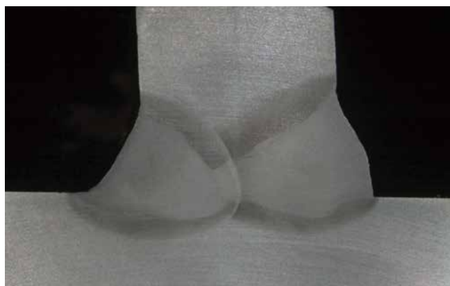
PB Spoina dwustronna z pełnym przetopem
