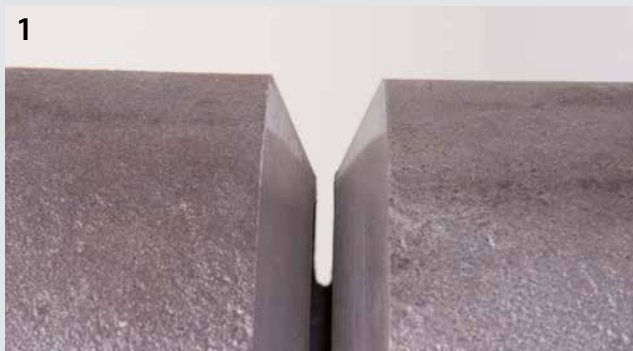
Przygotowanie spoiny graniowej na rurze, kąt rowka spawalniczego 60°, szczelina 3 mm
