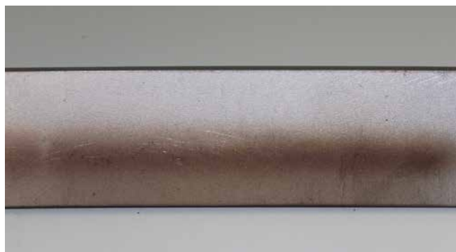
Ściana tylna: Mniejsze wprowadzane ciepła w forceArc puls®, mniejsze utlenianie powierzchni
