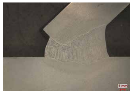
Grubość blachy średnicy 10 mm, kąt rowka spawalniczego 35°
